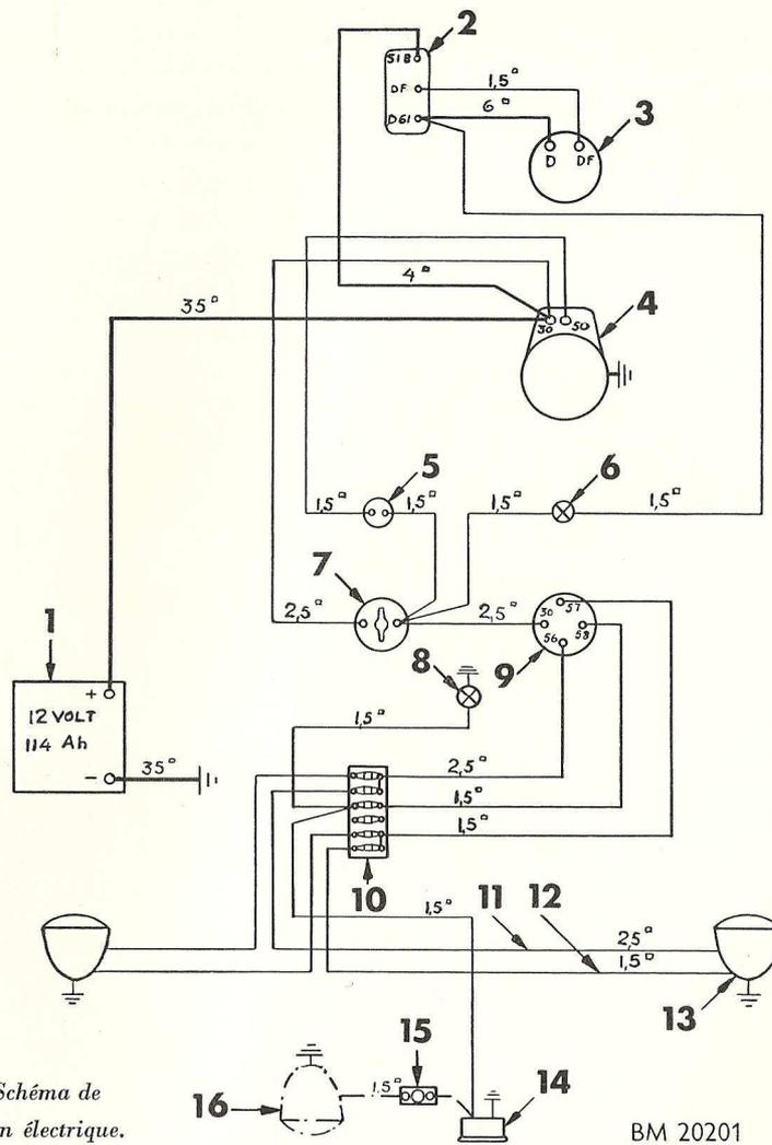
Fig. 36. Schéma de l'installation électrique.
