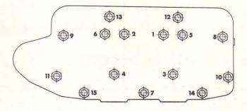
Serrez les écrous de culasse selon l'ordre indiqué sur la figure. Le couple de serrage doit être de 17.3 mkg
