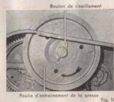
Poulie d'entraînement de la presse Fig. 18
