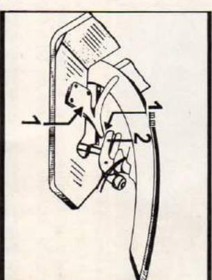
4. Les écarts par rapport à ces réglages — aiguille (1) allant trop ou pas assez loin — se corrigent à l'aide de la vis de réglage (2) du support d'aiguille (fig. 37).
