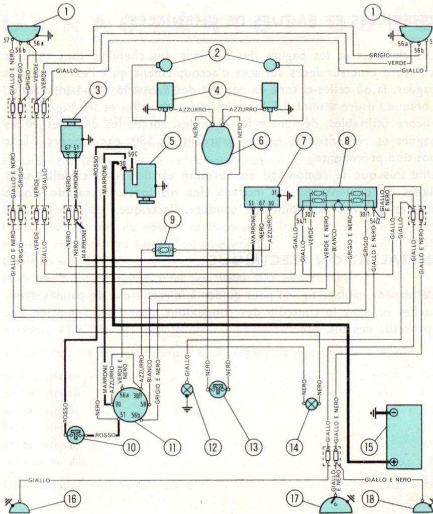
Fig. 44. - Plan de câblage (tension 12 Volts).
