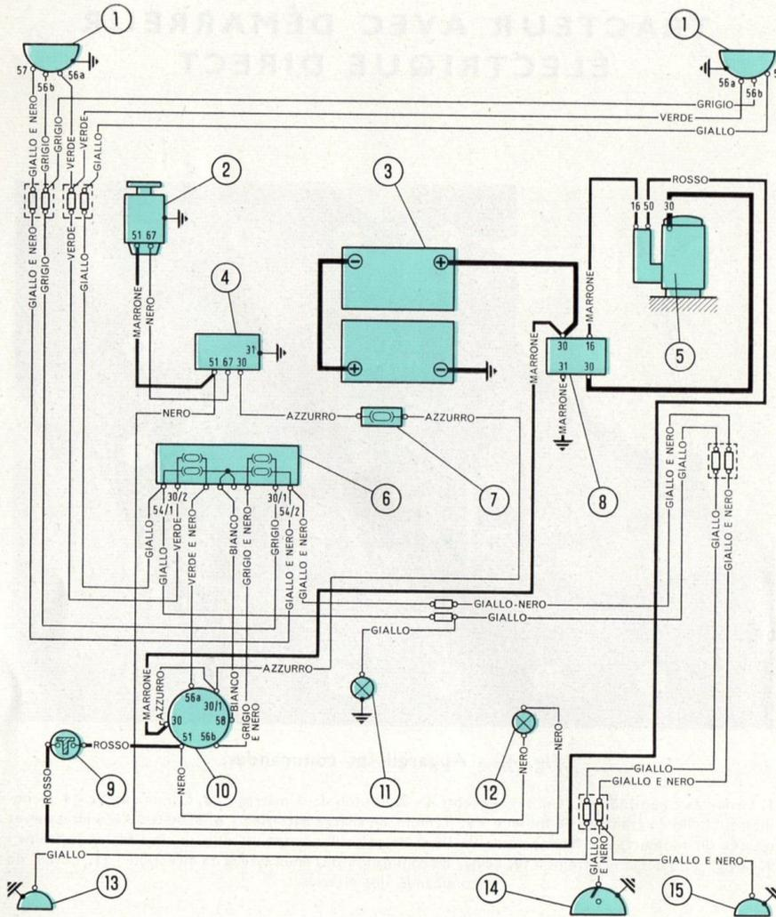
Fig. 46. - Plan de câblage (tension de 24 Volts).
