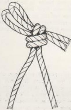
Noeud avec la boucle qui peut rester attachée au bec noueur en causant la rupture de la ficelle dans la partie supérieure de la balle.
