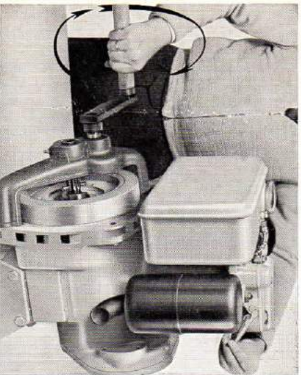
Planche 11 : Démarrage sans décompression automatique côté volant
