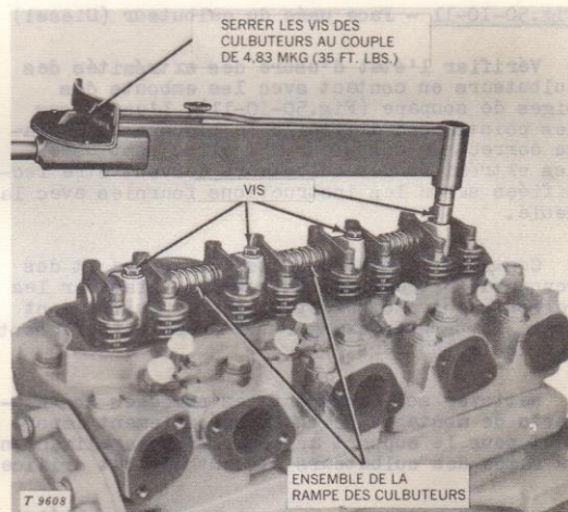
Fig.50-10-15 - Serrage de la rampe des culbuteurs
