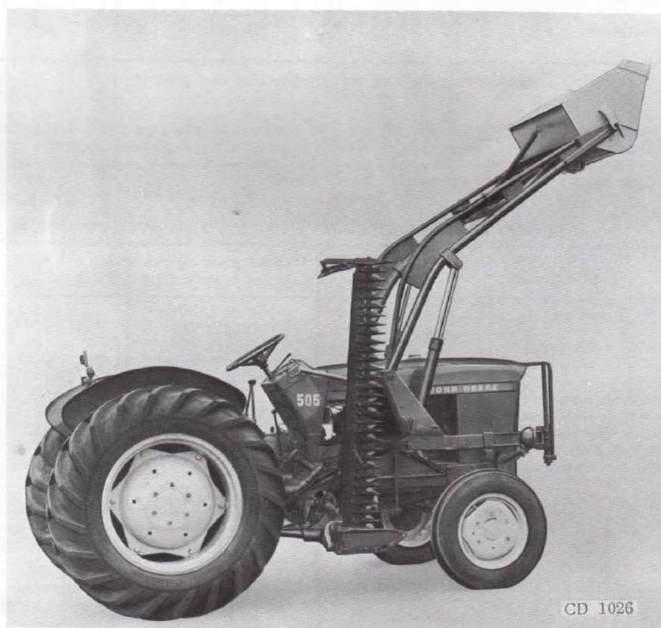
Fig. 3 - Chargeur frontal FC 55 équipé d'une benne à gravier, en extension
