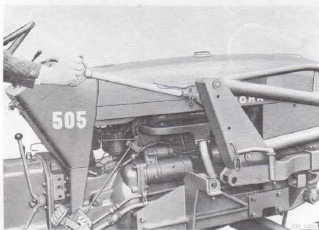
Fig. 11 - Support de bâti du chargeur
