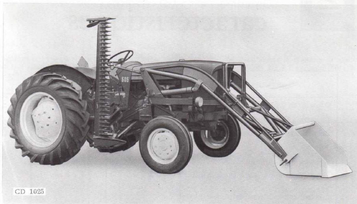
Fig. 2 - Chargeur frontal FC 55 équipé d'une benne à gravier, en position basse
