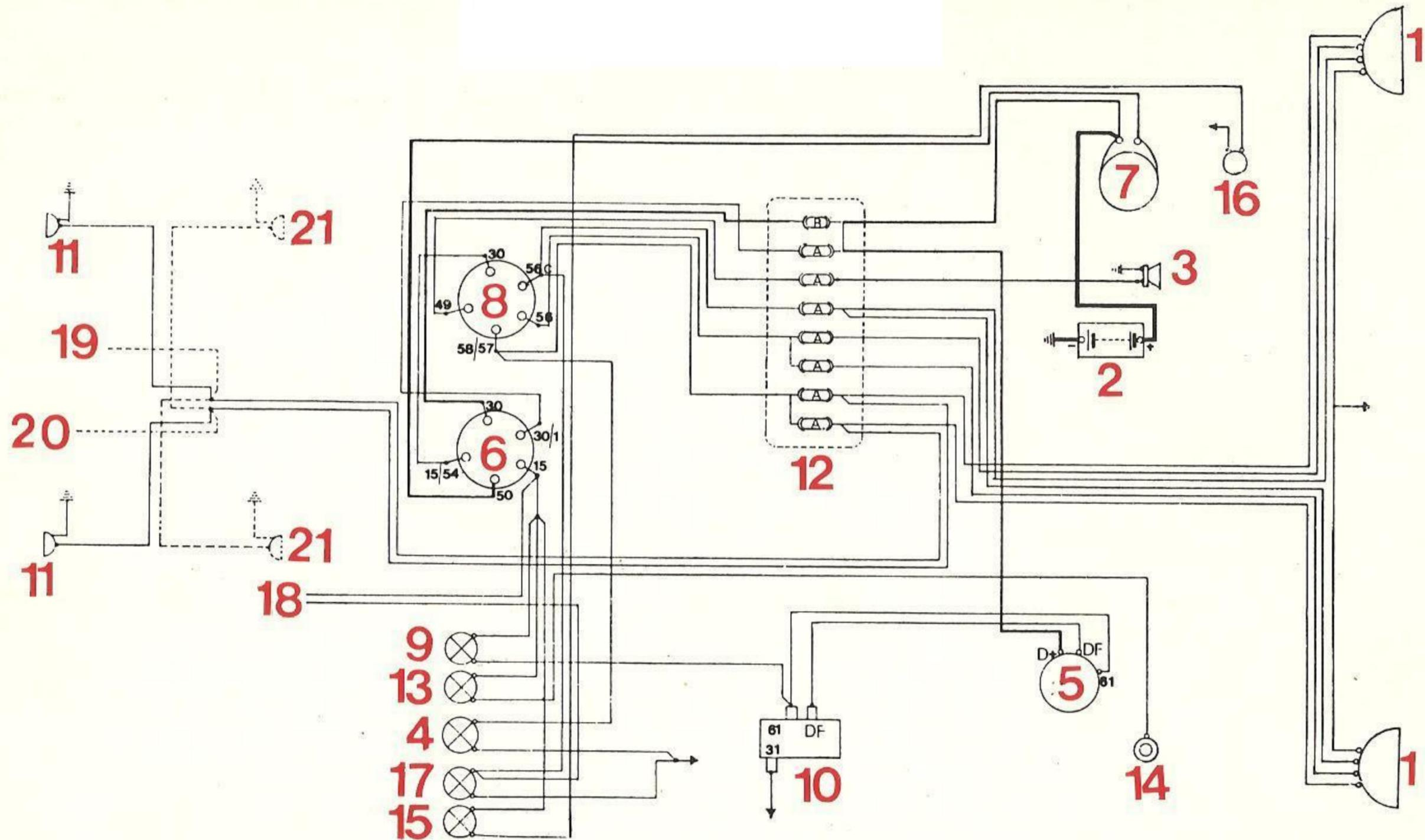
**Fig. 23 - Schéma de l'installation électrique**
