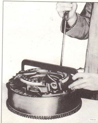
Fig. 12. - Utilisez la jauge IH n° 4720 pour vérifier la hauteur du levier de débrayage. (Embrayage double).
