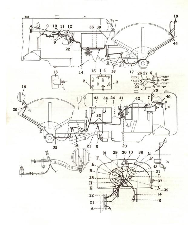
FIGURE 50 - Schéma de câblage du tracteur Utility Super FC-D
