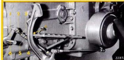
1. Levier de commande de débrayage.
