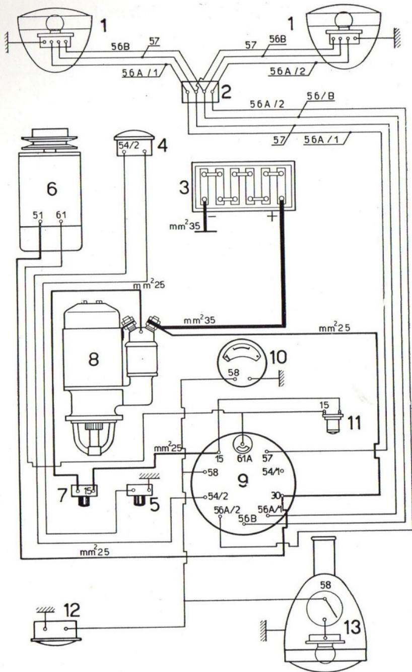
Fig. 21. — 1 - Projecteurs avant ; 2 - Boîte de connexion ; 3 - Batterie accumuleur ; 5 - Avertisseur acoustique ; 6 - Dynamo ; 7 - Bouton de démarreur ; 8 - Démarreur ; 9 - Boitier de distribution ; 10 - Manomètre d'huile ; 11 - Lampe-témoin pour contrôle courroie ventilateur ; 12 - Feu arrière ; 13 - Projecteur orientable.
