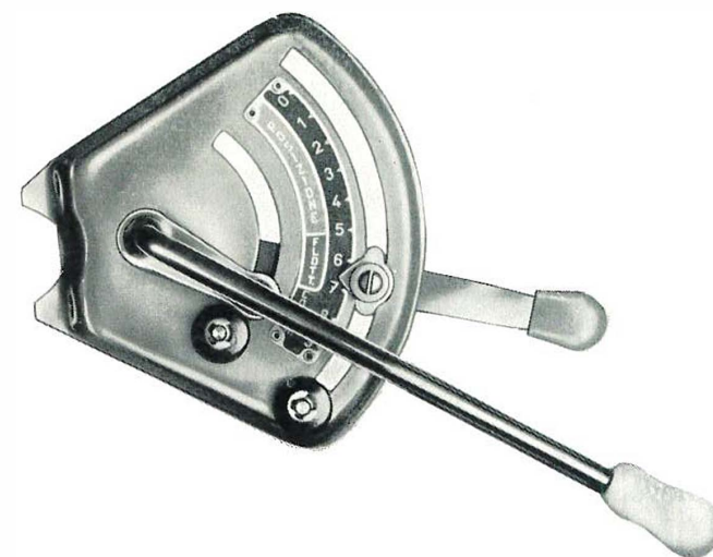
fig. 22 Position des manettes pendant le travail à effort contrôlé
