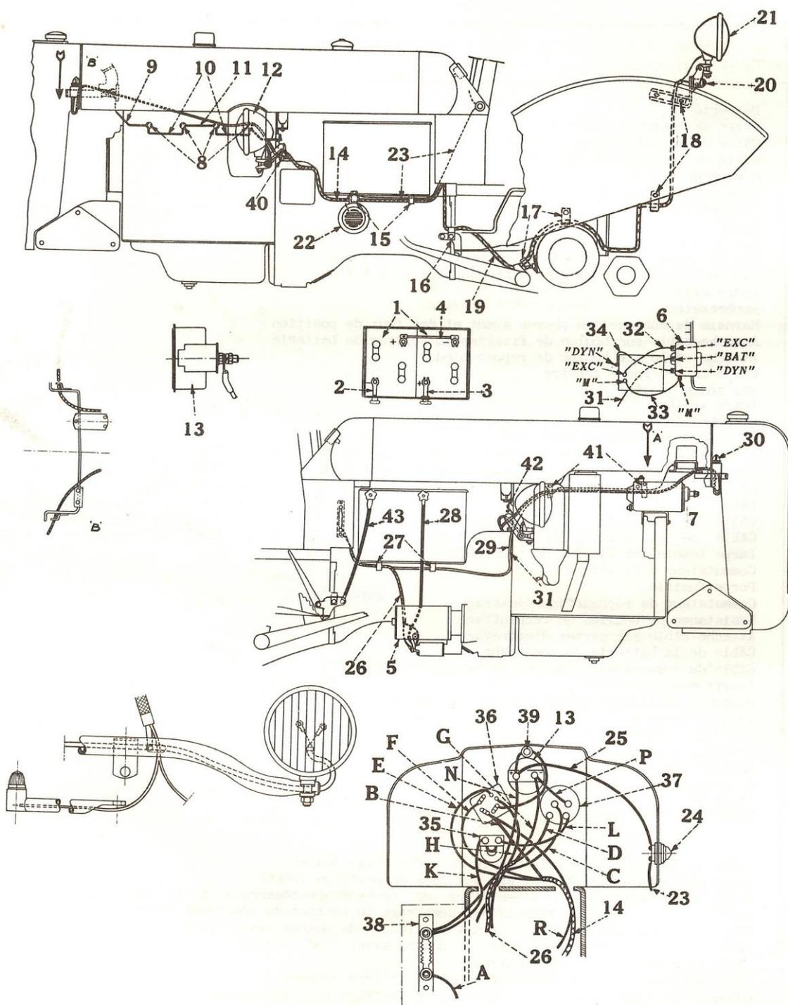
FIGURE 50A - Schéma de câblage du tracteur Vineyard Super FC-D
